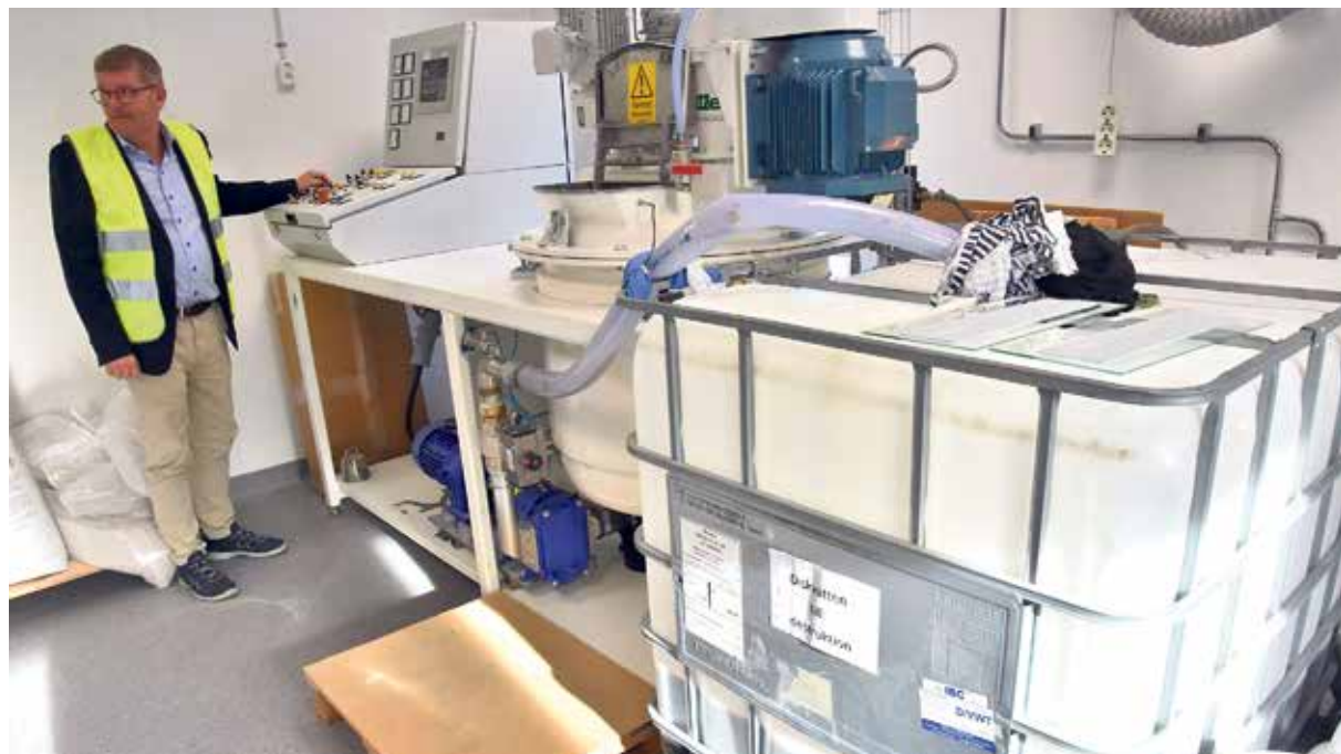
Vd:n Per-Olof Axelsson visar stolt upp den unika miniatyrmodell av Simfas spackelanläggning som finns i laboratoriet. I den kan nya recept testas innan de börjar tillverkas i full skala i byggnaden intill. Funkar det i modellen funkar det i den riktiga anläggningen.
